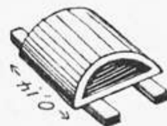
Muffel 14 cm Länge, 7,5 cm Höhe, 9 cm Breite.
